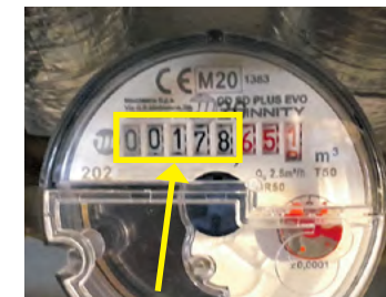
Bei Zählerstandsmeldungen bitte immer nur die Ziffern bis zum Komma angeben – in diesem Fall also 001788,5.
