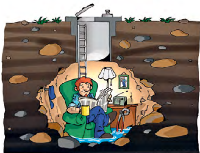
Die Brunnenstube ist ein frostfreier Raum, der als Zugang zum Brunnen und zur Installation der Rohrleitungsarmaturen dient.
